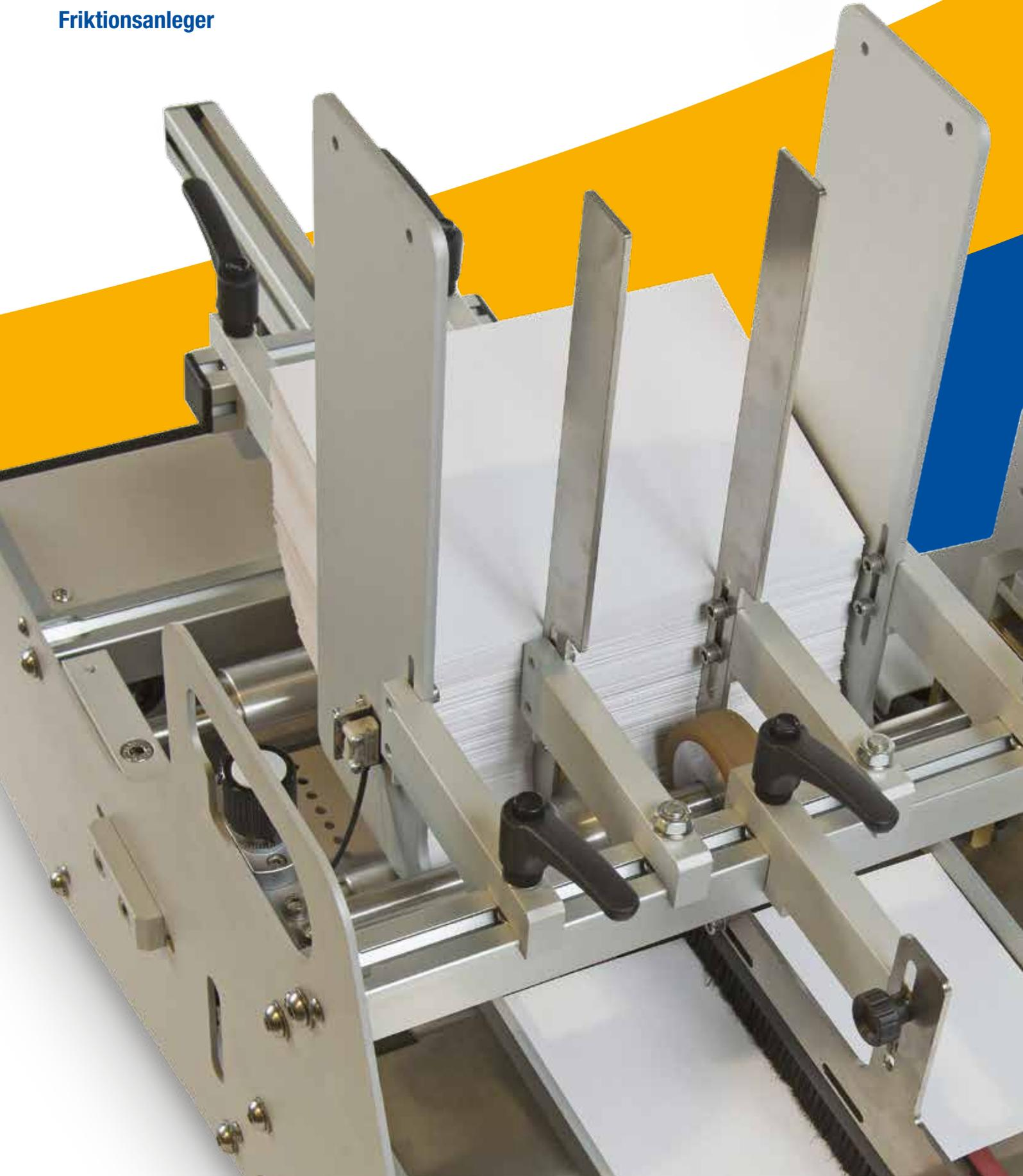
**WR FEEDER ist ein Friktionsanleger, der in der Lage ist, Blätter, Kärtchen, Schutzhüllen und Coupons bis zu einem maximalen Format von 250x300 Millimeter in der Version 250 oder 400x 300 in der Version 400 mit einem leistungsstarken Schrittmotor, der eine Beschickungsgeschwindigkeit von bis zu 70 Meter/Minute gewährleistet, zu bearbeiten.**
