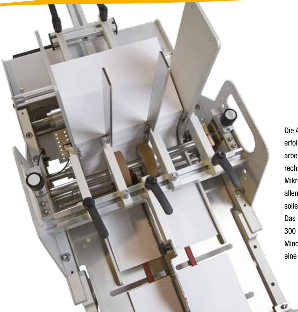
Die Auswahl des zu beschickenden Produktes erfolgt über Gummirollen, die gegenläufig arbeiten. Das System ist sowohl auf der rechten als auch auf der linken Seite mit Mikroreglern ausgestattet, wodurch es bei allen Produkttypen, die verwendet werden sollen, ausgesprochen flexibel ist. Das geräumige Lager mit einer Höhe von 300 Millimetern ist mit einer Kontrolle für die Mindestbefüllung ausgestattet und garantiert eine große Autonomie im Betrieb.
